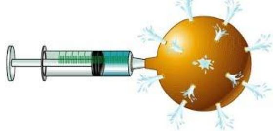
La prensa hidráulica es una máquina, basada en el principio de Pascal, que permite amplificar la intensidad de las fuerzas y constituye el fundamento de elevadores, prensas, frenos y muchos otros dispositivos hidráulicos.
